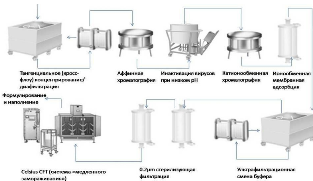
Рисунок 13 – Предложение по процессу выделения и очистки с помощью ультрафильтрации и хроматографии
